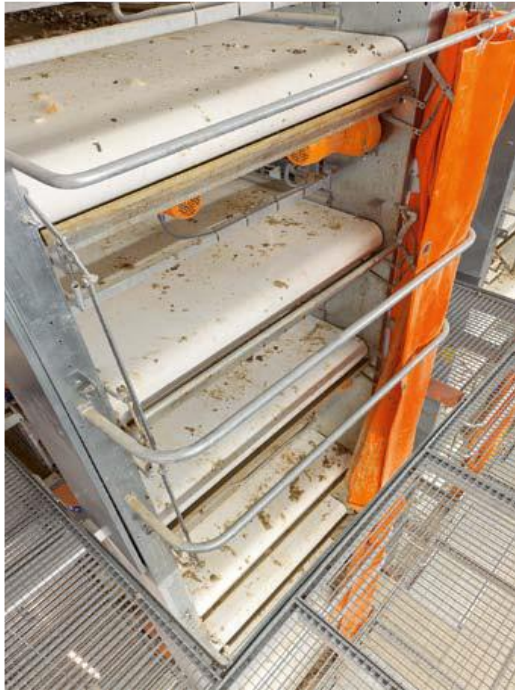
Slika 12.: Pogon traka za gnoj
