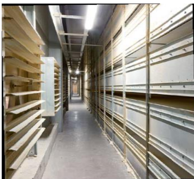
Slika 11.: Tunel sušenja gnoja
