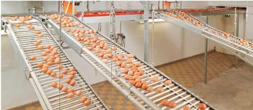
Slika 22.: Sustav transporta jaja u peradarniku
